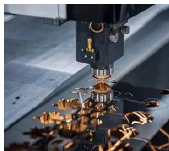
Cięcie blach najnowocześniejszym laserem Fiber
